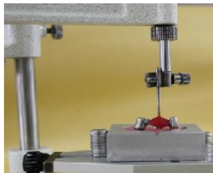
شکل ۲: مجموعه FDP راه‌نما-ابا‌نمنت-آنالوگ در داخل رزین
