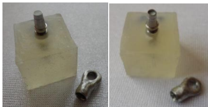
شکل ۱: الف) پرکردن ناقص حفره دسترسی اباتمنت ب) پرکردن کامل حفره دسترسی اباتمنت
