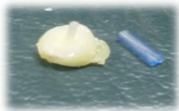
شکل ۳: نمونه‌ی استوانه‌ی کامپوزیتی آماده شده بر سطح دیسک عاج
