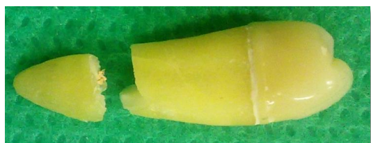
تصویر ۵: نمونه ای از شکست در پست و کور Custom Made زیرکونیا
