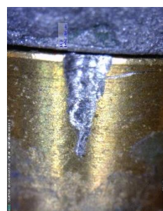
تصویر ۳: نمونه ای از اندازه گیری با میکروسکوپ نوری در گروه لحیم
