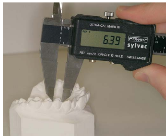
شکل ۱- اندازه گیری به روش دستی با استفاده از کولیس دیجیتال
